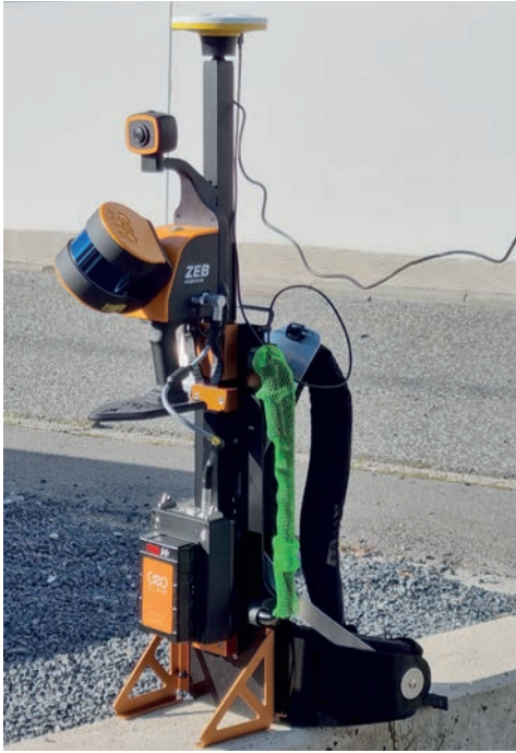
Abb. 2: Einsatzbereiter Rucksack-Scanner mit Scanner, Panoramakamera und GPS
